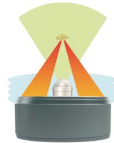
При однорядной локализации фирмы STORZ MEDICAL ультразвуковая и ударная волна проходят одну и ту же траекторию через организм пациента.
